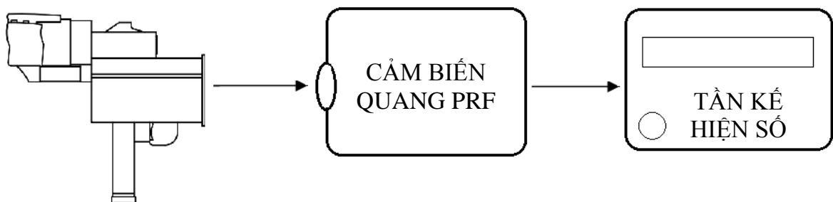
Hình 3. Sơ đồ kiểm tra sai số tần số lặp lại PRF
